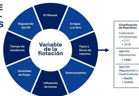
Figura N°4 Variables de flotación
